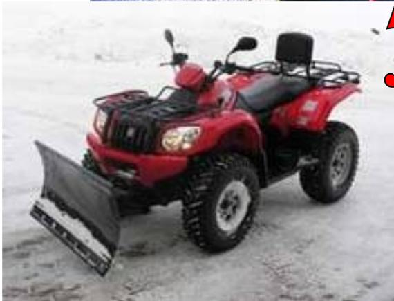
Die Atlas 500 - mit ihrem flüssigkeitsgekühlten Halbliter-Motor - hat mit 32,5 PS ausreichend viel Kraft, um ihr Eigengewicht von 342 kg locker auf 80 km/h (gedrosselt) zu beschleunigen. Sie ist mit modernster Antriebstechnik ausgerüstet. Der Allradantrieb lässt sich elektrisch zuschalten, das vordere Differenzial kann per Knopfdruck gesperrt werden. Einzelradaufhängungen mit doppelten A-Arms an allen Rädern demonstrieren den hohen Stand der Fahrwerkstechnik.
